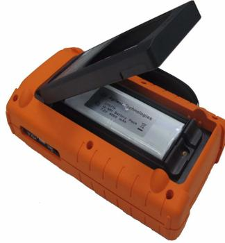
**그림 8-5** 스탠드를 분리하지 않고 배터리 팩 커버를 분리합니다
