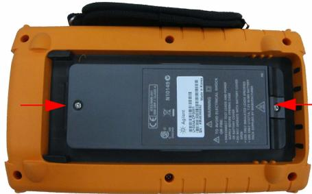
그림 8-3 배터리 커버 나사를 분리합니다
