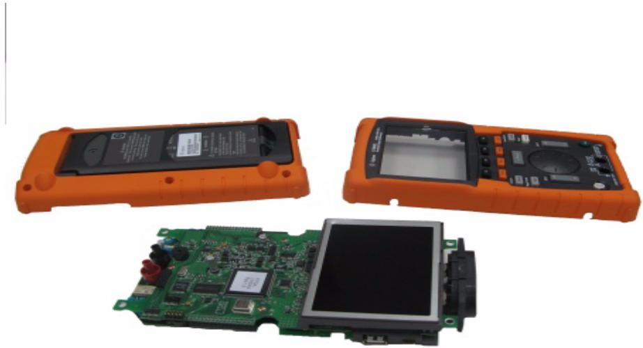
**그림 8-10** 계측기 PCBA에서 앞면 케이스(오른쪽) 및 뒷면 케이스(왼쪽) 분리
